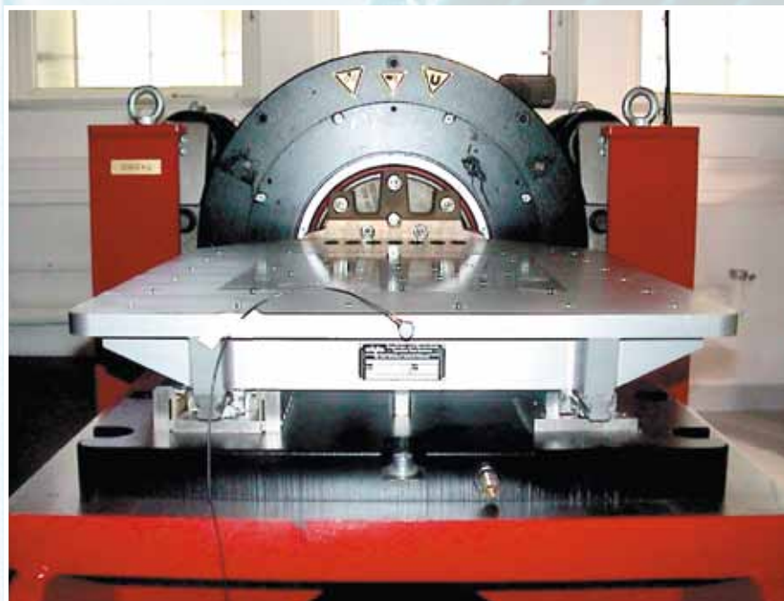
Elektrodynamischer Schwingtisch mit Gleittisch
